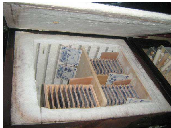
Der 3. Brand, der Muffelbrand, bei dem der Dekor eingebrannt wird
