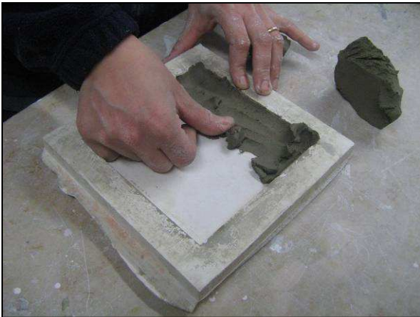
Eindrücken des feuchten Tons in die Modellform
